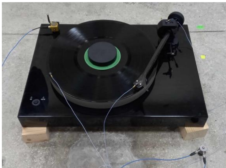
Rysunek 1: Rozmieszczenie czujników na wkładce, ramieniu, talerzu, obudowie i podłożu
